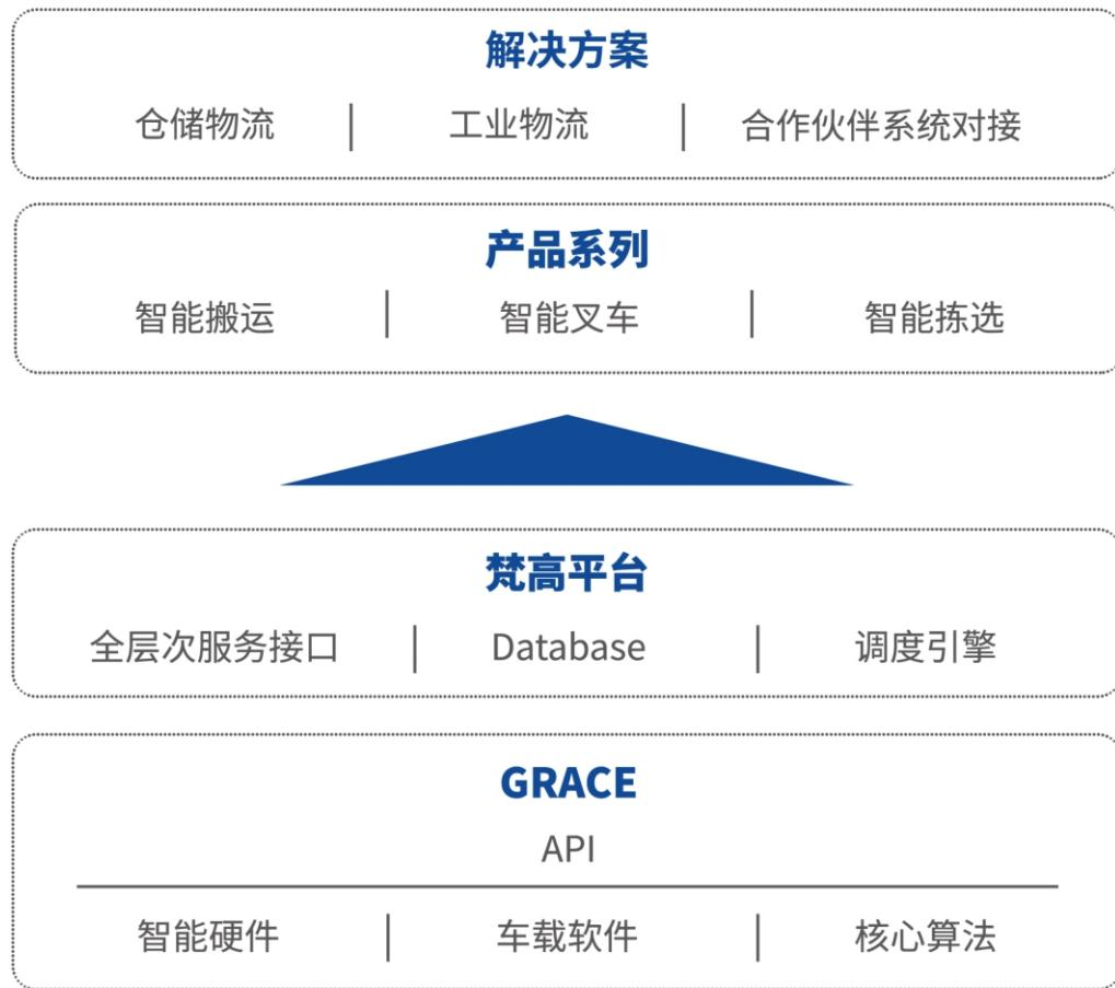
国自的大物流战略将系统划分为基础能力层和产品服务层。其中，基础能力层聚焦于稳定的平台软件，算法以及CNES(电控、网络、电池、安全)四大子系统，以技术平台方式提供通用的技术，大幅提高资源弹性及利用率，提升产品上市速度。
