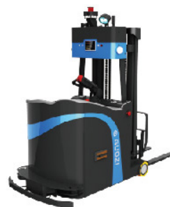
1.5T平衡重式机器人
