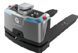
Atom-Smart 1T搬运机器人 柔性支腿 避免打滑
